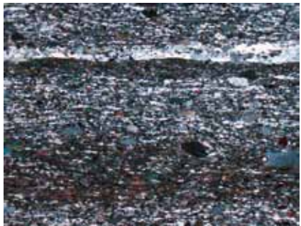
Fig 3.7 Kvartsitskiffer, tunnslip. Kvarts, fältspat och glimmer har parallellstruktur och bildar en utpräglad skiffrighet. Verklig storlek: längd 5,5 mm.
