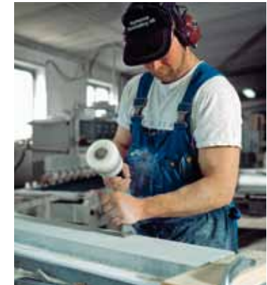
Fig 7.3 Lågerhuggning av kalksten med klubba och mejsel
