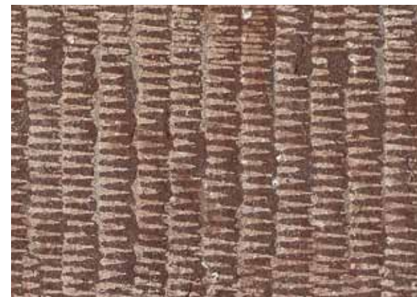
Fig 7.11 Tandhuggen, röd kalksten. Nyhuggen, skala 1:1
