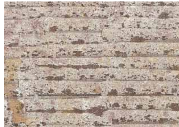
Fig 7.10 Läghuggen, gråbrun kalksten. Nyhuggen, skala 1:1
