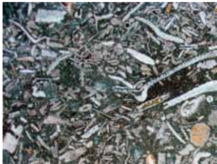
Fig 3.12 Kalksten, tunnslip. Kalkspat med finkornig textur och skalfragment. Verklig storlek: längd 5,5 mm.
