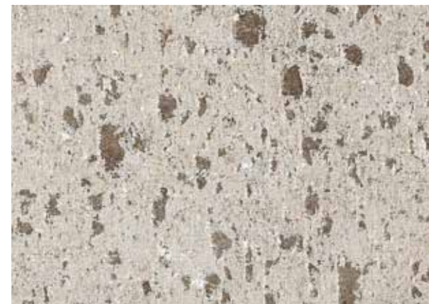
Fig 7.12 Normalhyvlad, gråbrun kalksten. Nyhyvlad, skala 1:1
